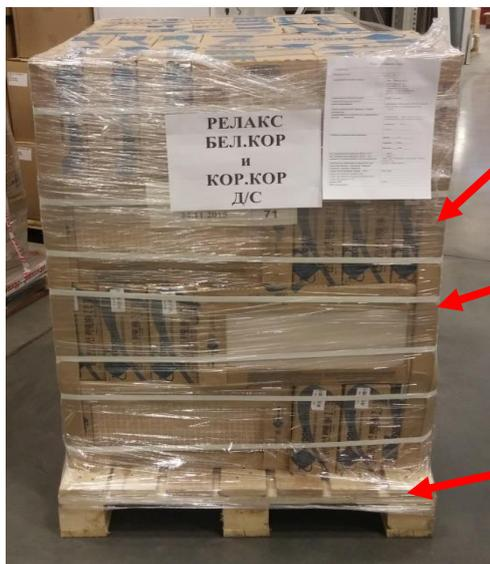
Дополнительные ребра жесткости
